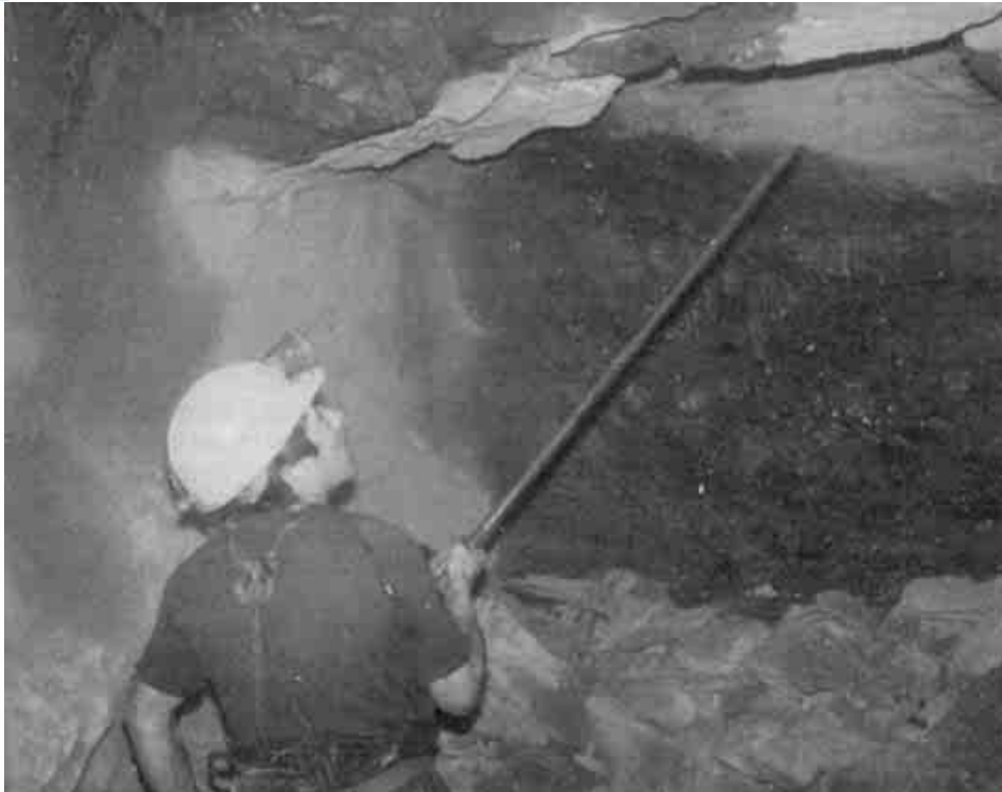
MINERO DURANTE LA ACTIVIDAD DE LIBERAR EL TECHO DE ROCAS SUELTAS CON LA BARRA PARA ESTE FIN (TOJEADORA)
